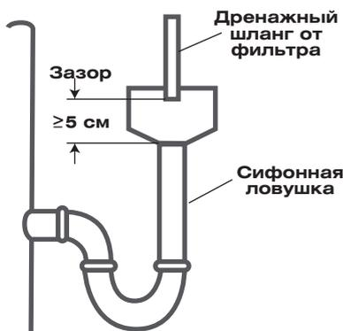
Наиболее оптимальным является установка фильтра выше уровня линии дренажа и на расстоянии не более 6,1 м от него. Используя подходящие фитинги (в комплект поставки не входят), присоедините пластиковый шланг к дренажному выходу на управляющем механизме. Диаметр и длину дренажной линии необходимо подбирать таким образом, чтобы обеспечить минимальное гидравлическое сопротивление при обратной промывке.
