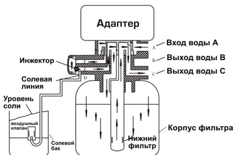
Необработанная вода входит в клапан через вход **A**, далее проходит через центральную часть клапана к соплу инжектора, проходит через него, далее проходит через слои смолы, через нижний фильтр, затем идет снизу вверх по подъемной трубе в корпус клапана, через его центральную часть и выходит через слив **S**.
