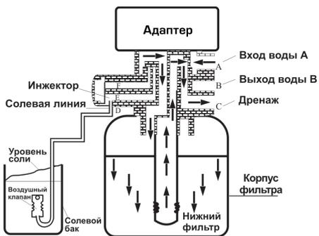
Необработанная вода поступает в адаптер по каналу **A**, далее через центральную часть адаптера поступает в фильтр, далее через фильтрующий материал и нижний фильтр вода попадает в подъемную трубу. Двигаясь вверх, по подъемной трубе поднимается и через центральную часть адаптера попадает к выходному каналу **C**.
