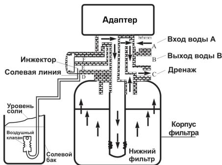
Необработанная вода поступает в адаптер по каналу **A**, далее через центральную часть адаптера поступает в нижнюю часть фильтра (по внутренней части подъемной трубы). Далее вверх через фильтрующий материал, через центральную часть адаптера к выходному каналу **C**.
