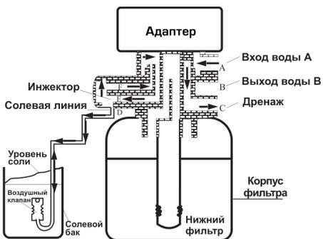
Необработанная вода входит в адаптер через вход **A**, через центральную часть адаптера к выходу инжектора **E** и через соединительный элемент солевого бака **D** попадает в солевой бак. Другая часть воды проходит через выход инжектора **E** и через небольшое отверстие к входу инжектора **F**, затем через корпус адаптера, центральную часть адаптера и выходит через слив **S**.
