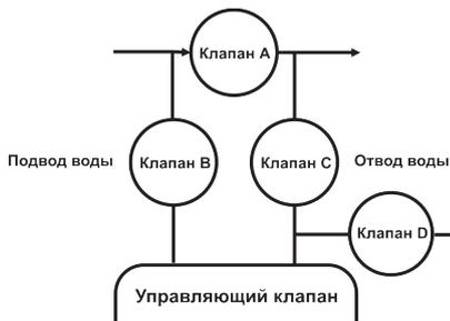
Подключение фильтра к магистрали исходной и очищенной воды следует выполнять в соответствии с рисунком.
