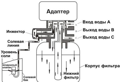
Необработанная вода входит в клапан через вход **A**, проходит через внутреннюю часть к входу инжектора **F**, далее быстро течет к выходу инжектора **E**, где создается отрицательное давление. При этом рассол засасывается в клапан из положения **D**, далее поступает в верхнюю часть резервуара. Рассол проходит через слой смолы сверху вниз, далее через нижний фильтр, вверх по подъемной трубе, через корпус клапана, через центральную часть клапана и выходит через слив **S**.
